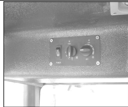
Abbildung 3-44 Bedienfeld der Klimaanlage
